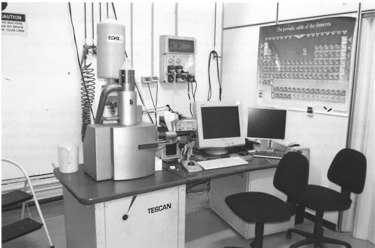
Figura 2: microscopio elettronico a scansione Vega TS Tescan Univac 5163 XM con analizzatore a dispersione di energia EDAX Genesis 4000 XMS Imaging 60 SEM, in dotazione presso il Dipartimento di Scienze dell'Ambiente e del Territorio e di Scienze della Terra dell'Università degli Studi di Milano-Bicocca.
